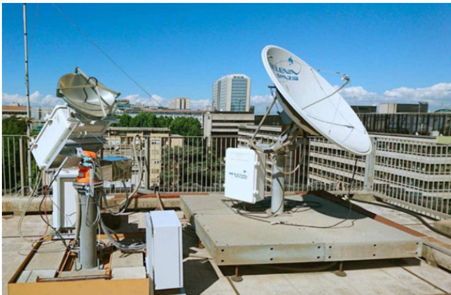
Figura 1 – Stazione ricevente Alphasat in banda Ka e Q, dislocata presso la sede Roma EUR del MIMIT. Sul lato destro si nota il ricevitore in banda Ka, a sinistra quello in banda Q
