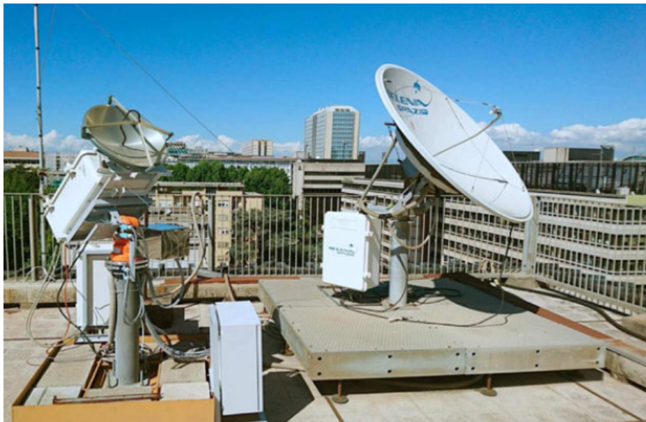
Figura 1 —Stazione ricevente Alphasat in banda Ka e Q presso il MIMIT, Roma.
