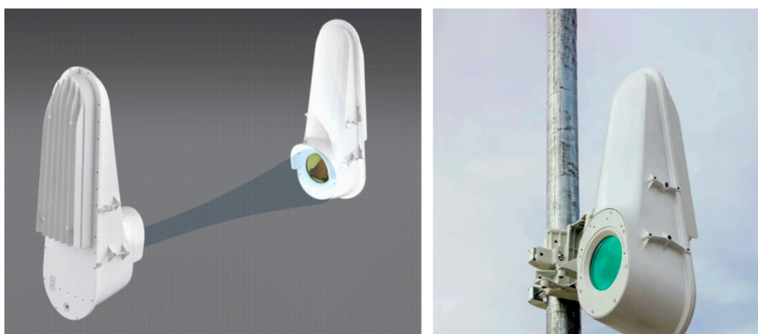
Figura 7 – Testine FSO utilizzate nel progetto "TAARA" di Google X: (a) layout in linea di vista (LOS), (b) installazione fisica del sistema [10].
