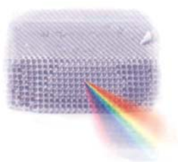
Fig. 4 – Struttura PBG. I pori che si intravedono sono celle fabbricate artificialmente di dimensioni nanometriche.
