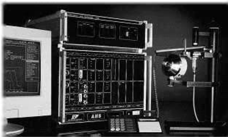
Eurolab Terminal Equipment - Uff.4° - Servizio PSTN: Sistema automatico per prove: NET4 (parte comune e parte nazionale) e CTR2
