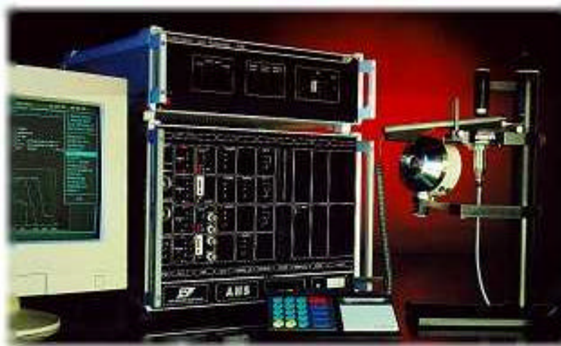
Eurolab Terminal Equipment - Uff.4° - Servizio PSTN: Sistema automatico per prove: NET4 (parte comune e parte nazionale) e CTR21;
