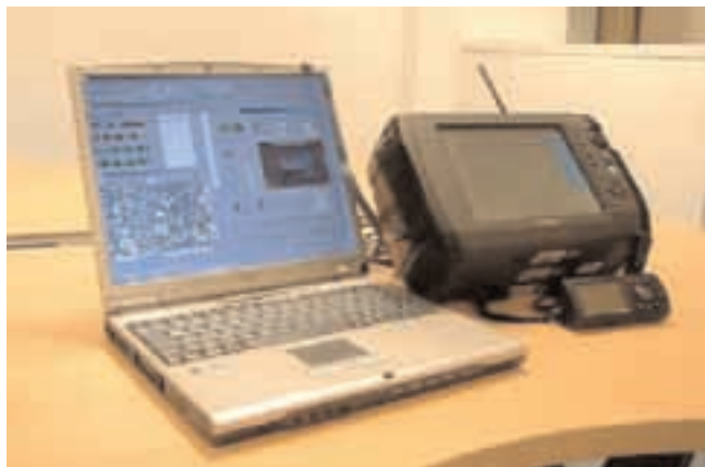
Fig 8.3: foto di un banco di misura UMTS, rappresentante Scanner e telefoni di test collegati ad un PC
